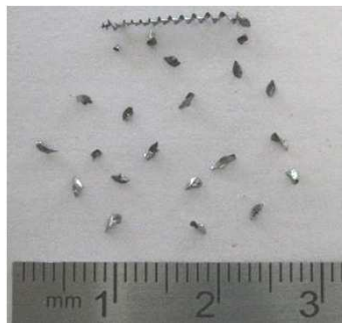
Bohrer nach 500 Bohrungen
