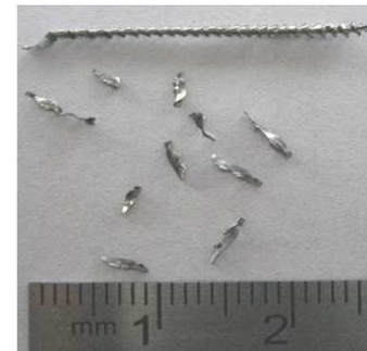
Bohrer nach 363 Bohrungen
